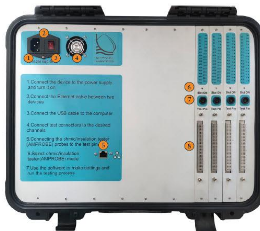
شکل ۳- بخش‌های مختلف کیف جانبی تستر
