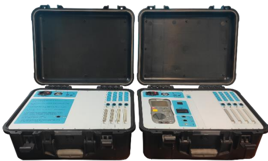
شکل ۱- تصویری از دستگاه تستر کابل ساخته شده
