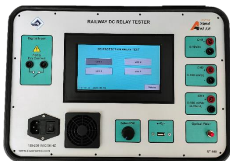
شکل ۱- تصویری از دستگاه تستر رله DC ساخته شده
