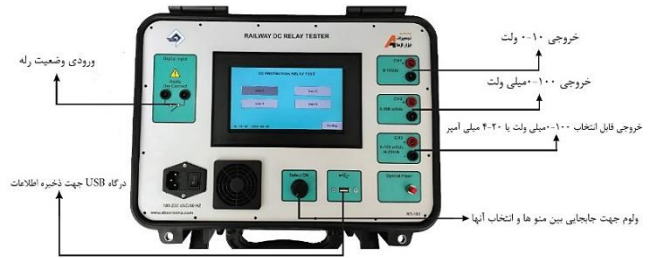
شکل ۳- معرفی بخش های مختلف دستگاه ساخته شده
