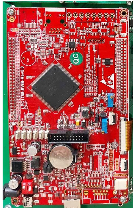
شکل ۷ - ماژول برد راه انداز میکرو کنترلر ARM LPC1788 با اجزای جانبی
