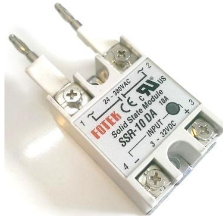
شکل ۴- رله SSR جهت انجام تست های خانواده DDL
